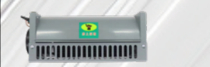
GNL-FB9K(R)-13 • FB-9K(L) - 风机 • Rotate Speed:1250(rpm) - 转速 • Air Volume:4.8(m 3 /min) - 风量 • Power:25(w) - 功率 • Outlet Size:270X43(mm) - 外尺寸 • Install size:288X90(mm) - 安装尺寸
