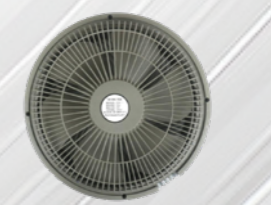
GNL-XZ352A-18 • XZ352A - 风机 • Rotate Speed:1250(rpm) - 转速 • Air Volume:7(m 3 /min) - 风量 • Power:28(w) - 功率 • Outlet Size:392X34(mm) - 外尺寸 • Install size:412X90(mm) - 安装尺寸
